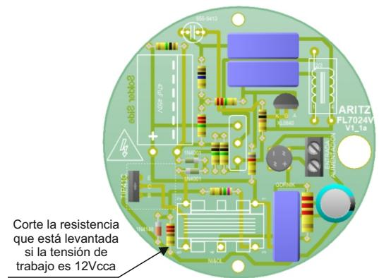
**NOTA.: Una vez cortada la resistencia que está levantada si la tensión de trabajo es 12Vcc a**
